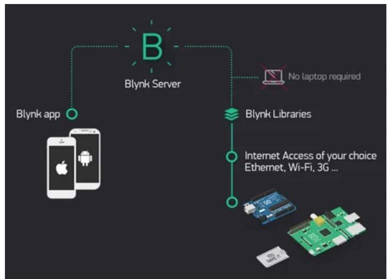
El firmware en el dispositivo se puede programar muy fácilmente utilizando ArduinoBlocks, es por ello que la combinación ArduinoBlocks + Blynk permite desarrollar proyectos IoT muy potentes en un tiempo récord.
