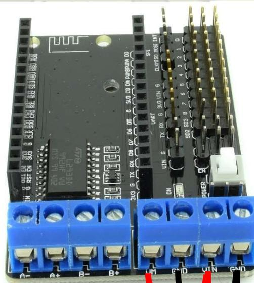
Alimentaremos de forma paralela la placa NodeMCU y el driver de motores tal y como se muestra en la imagen.
