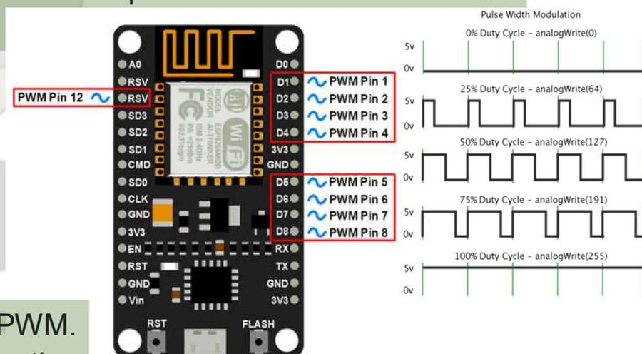
No todos los pines de la placa NodeMCU tienen control PWM. Sólo los pines reflejados en la siguiente imagen, por ese motivo no podemos utilizar los pines D0 y D4 para tal fin.
